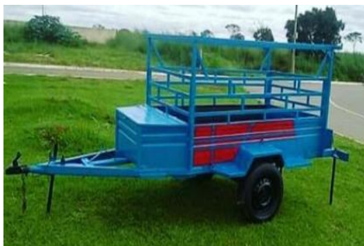
Exemplo de modelo de reboque carretinha para o transporte de cilindros
