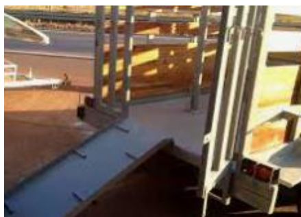
Carretinha para o transporte de GMG's Móveis com rampa para facilitar o embarque e o desembarque de GMG's.
