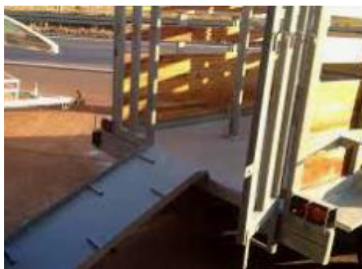
Reboque carretinha para transporte de cilindros com rampa para facilitar o embarque e desembarque de cilindros e até GMG's móveis
